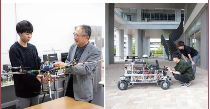
自動車や航空機を対象として、走行制御システムや、運行時の安定性・操縦性を向上させるための研究に取り組んでいます。GPS、ジャイロセンサや障害物センサを用いて、所定のルート・速度で車両を無人走行させる車両誘導制御実験や、ドローンの高度制御実験を行っています。学生たちは自分たちで実験車両やドローンを動かし、試行錯誤を重ねながら摩擦や振動の影響を最小限に抑えて性能の向上を図るにはどうしたら良いかを考え、実力を磨いています。
