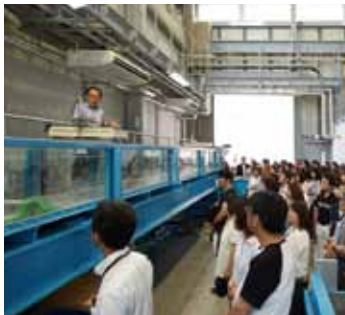
実験水路／急激な河川水位の上昇によって堤防が決壊する状況を再現し、どのように堤が崩壊していくかのメカニズムを解明する実験などを行います。
