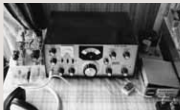
ささやかな無線局。真ん中が市販の受信機FR-50B、左の小さいのが自作の電信送信機（出力5W） （写真提供／児玉隆治）
