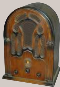
再生検波3球真空管ラジオ 小型の砲弾型キャビネット、この時代を代表する形態である 1932年頃
