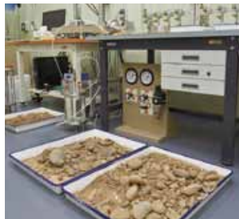
信濃川の砂礫／国土交通省と共同で日本全国の河川堤防に関する研究を進めており、取材時は信濃川で採取してきた砂礫の力学試験を行っている最中でした。
